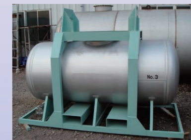
ケミカル用移動タンク
