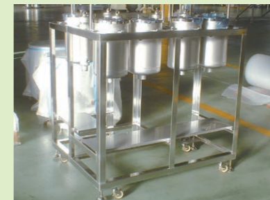
食品仕込みタンク
