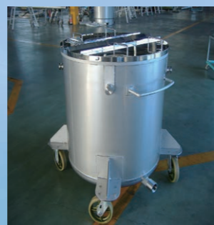
ケミカル用移動タンク
