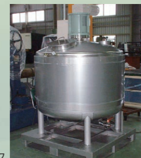
1000ℓ攪拌タンク
