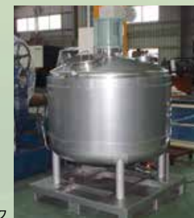
1000ℓ攪拌タンク
