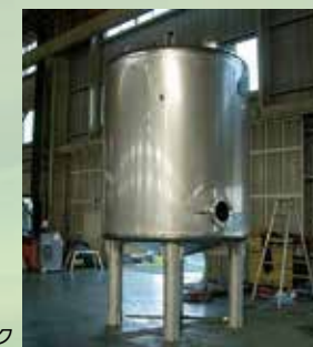
4000ℓ貯蔵タンク
