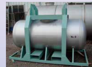
ケミカル用移動タンク
