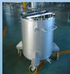
ケミカル用移動タンク
