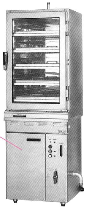
TLB-2EC 外形寸法: W580 x D610 x H1740 消費電力: 三相200V 9.2kw 蒸気発生量: 14ℓ 引出寸法(内寸): W433 x D488 x H40
